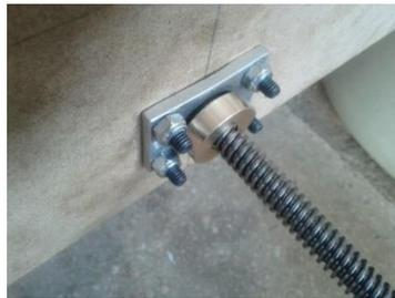
*Figura 26.* Mecanismo Tuerca-Tornillo de potencia
