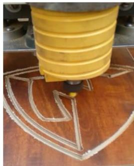
*Figura 82.* Mecanizado de la figura de prueba
