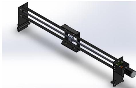
*Figura 49.* Esquema del carro eje Y
