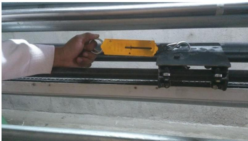
*Figura 21: Pruebas para obtener la fuerza de empuje.*
