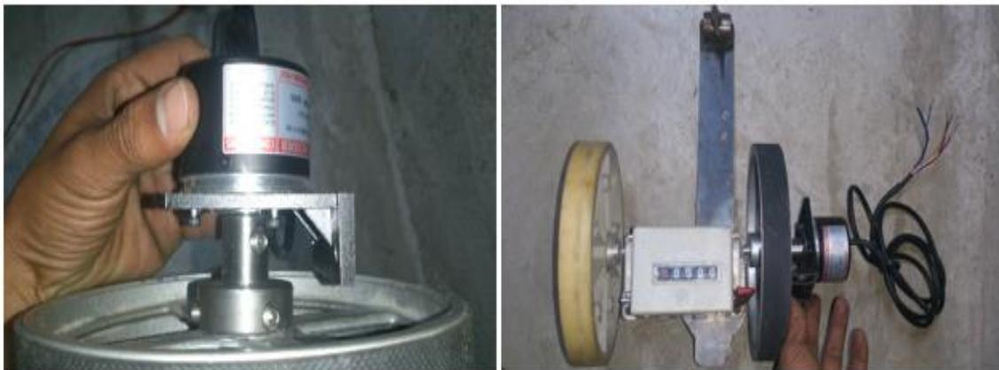
*Figura 33. Acople para toma de referencia entre ppr y metros*
