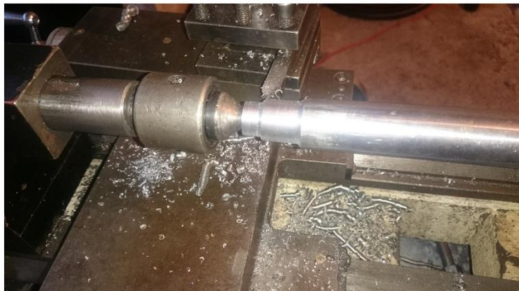
Figura 44. Torneado del eje en acero AISI 4340
