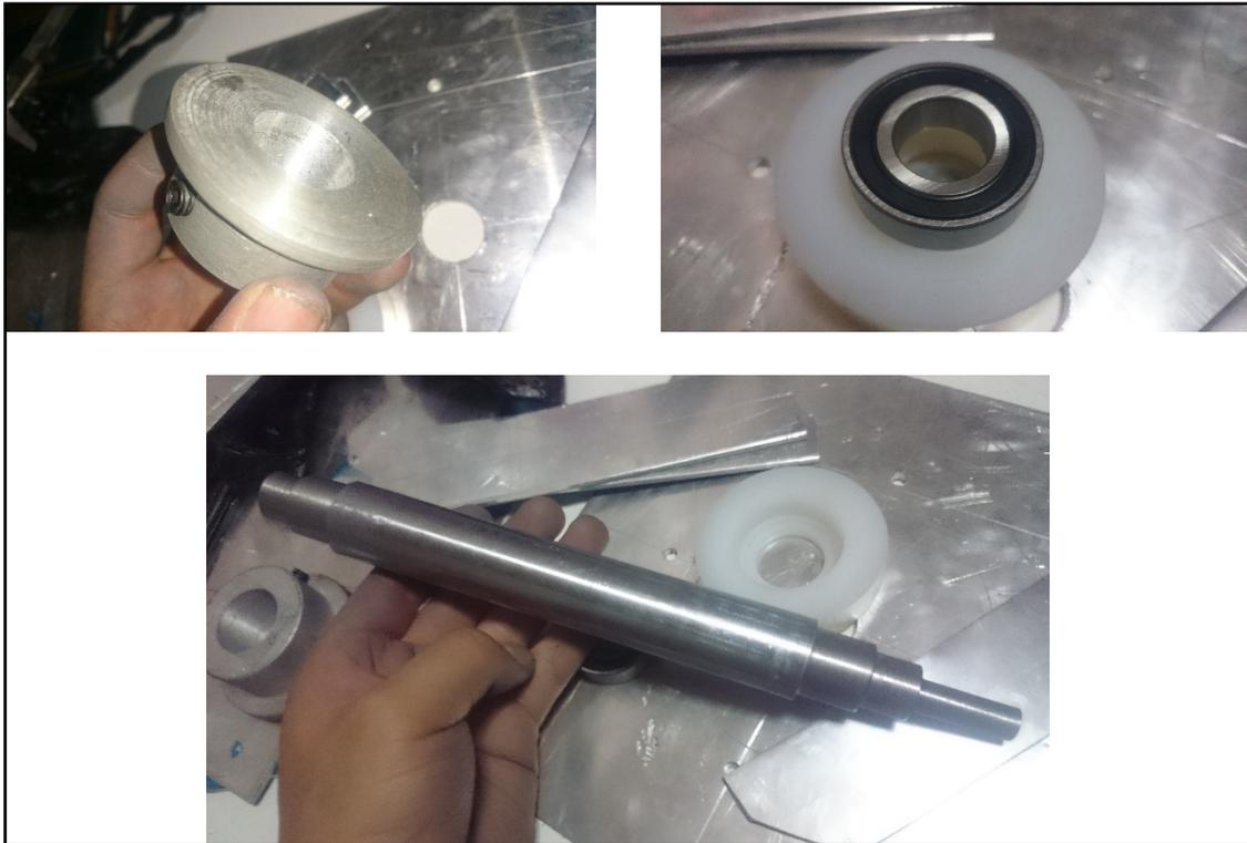
Figura 46. Brida de sujeción, porta-rodamiento y eje terminados
