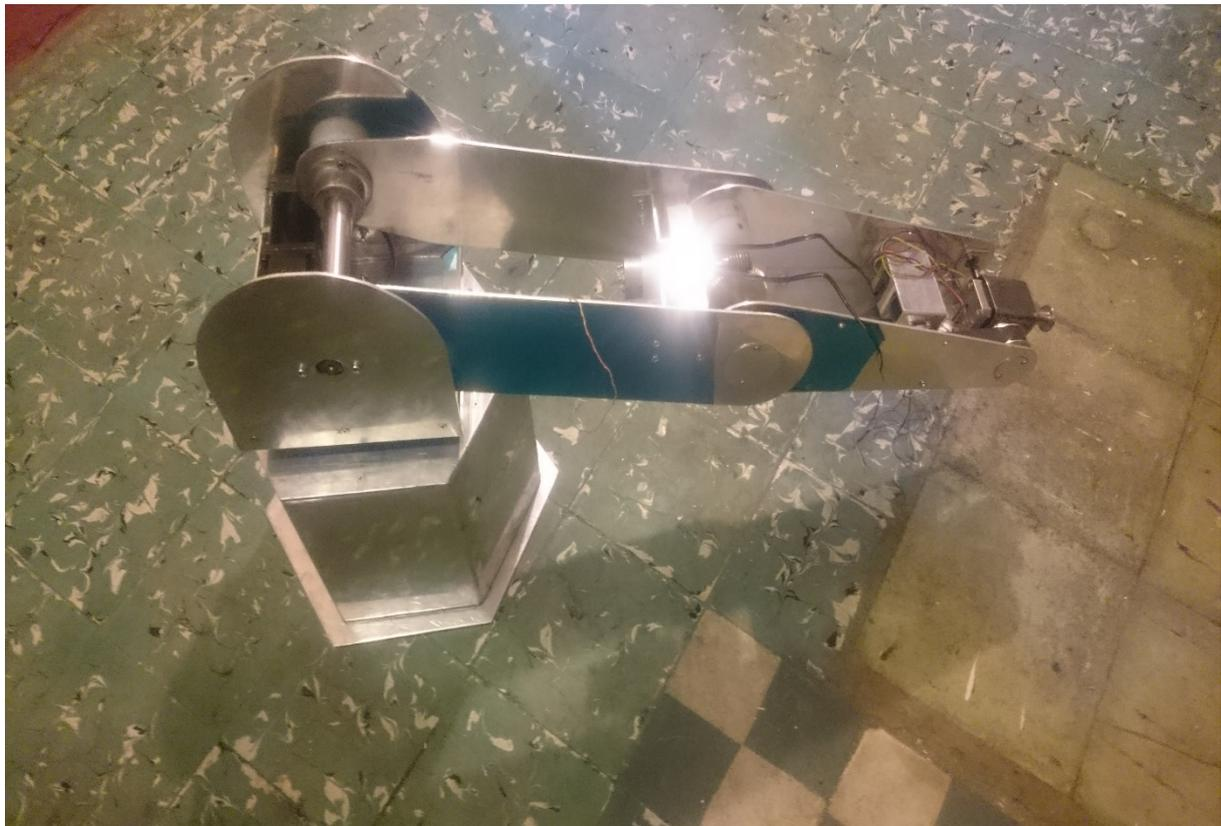
Figura 47. Ensamblaje del brazo y hombro con el BRUTN
