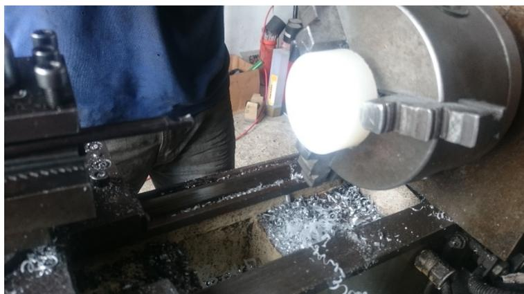
Figura 45. Torneado porta-rodamiento en nylon
