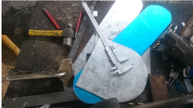
Figura 43. Corte de los laterales para hombro y brazo
