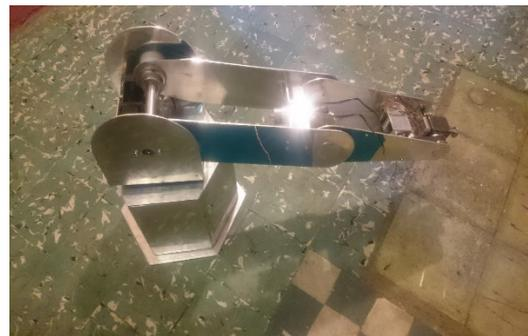
Fig. 12. Ensamblaje del brazo y hombro con el BRUTN
