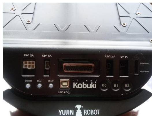
Panel de Conexión y Control
