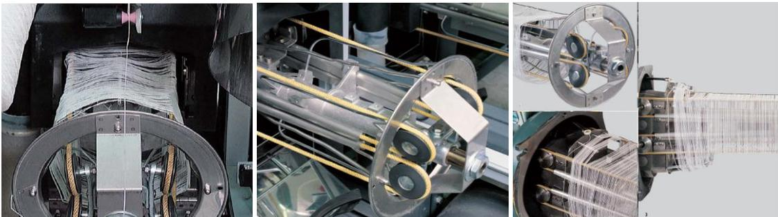
El tratamiento del hilado se efectúa mediante un sistema por circulación forzada del aire calentado por las resistencias eléctricas. El tratamiento se puede realizar también con vapor saturado (opcional).
