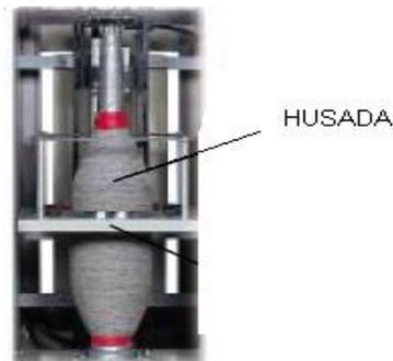
Esta maquina esta equipada de una corre tangencial, para accionar todos los husos de la máquina Retorcedora, con menos ruidos y ahorro de energía. Actualmente existe la posibilidad de accionar cada huso con un motor individual, sistema que se utiliza para hilos que exigen una gran regularidad de torsión.
