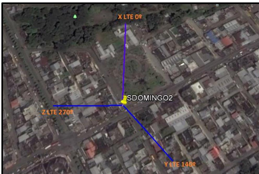
**Figura 47.** Azimuts de LTE en Google Earth
