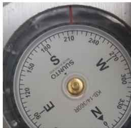
Fotografía de la medición del azimut del sector Z UMTS utilizando la brújula, la línea de color rojo indica que el azimut es de 215°.
