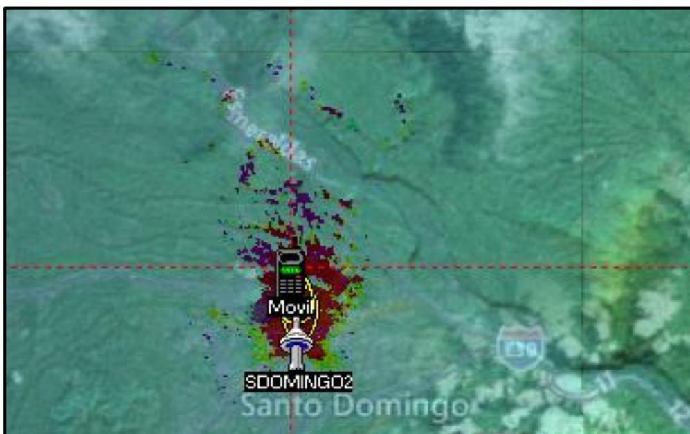
**Figura 99.** Zona de Cubertura del Sector X LTE en la banda de 2100MHz
