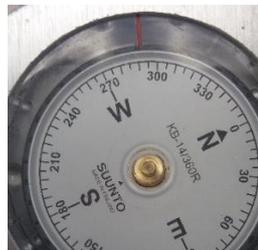
Fotografía de la medición del azimut del sector W UMTS utilizando la brújula, la línea de color rojo indica que el azimut es de 290°.
