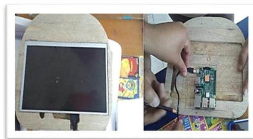
Fig. 9. Armazón de madera del módulo interactivo
