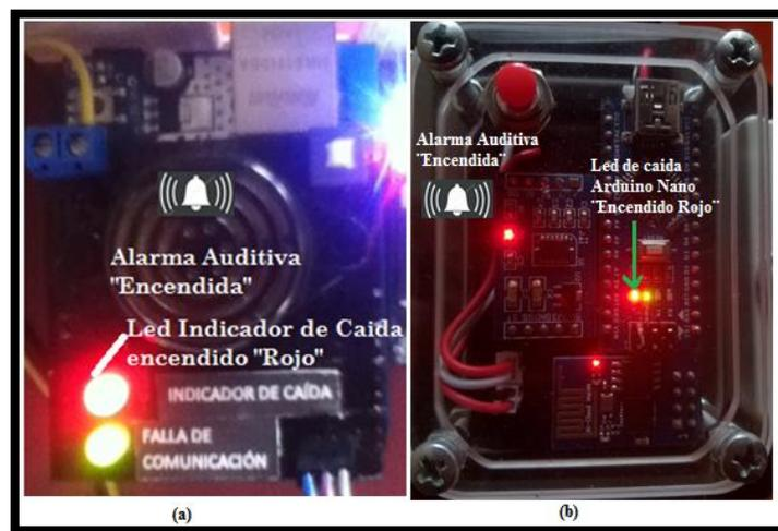
Figura 71: Alarma auditiva y Visual (a) Módulo Central (b) Módulo Sensor.
