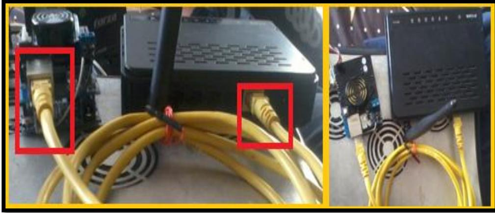
*Figura 14: Conexión del Router al Shield Ethernet (Indicador de alarma)*
