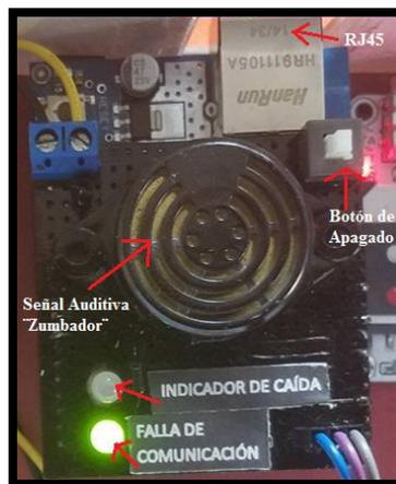
*Figura 76:Elementos del módulo indicador de alarma.*
