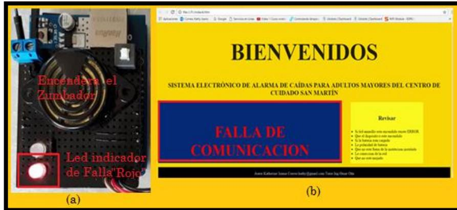
Figura 28:(a) Estado del indicador de alarmas (b)Servidor Web
