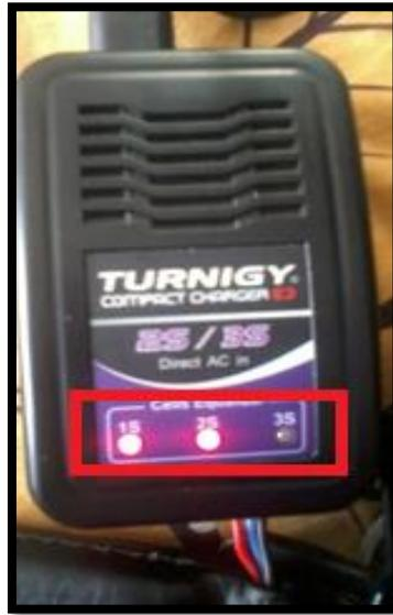
*Figura 788: Inicio de cargado de la batería*
