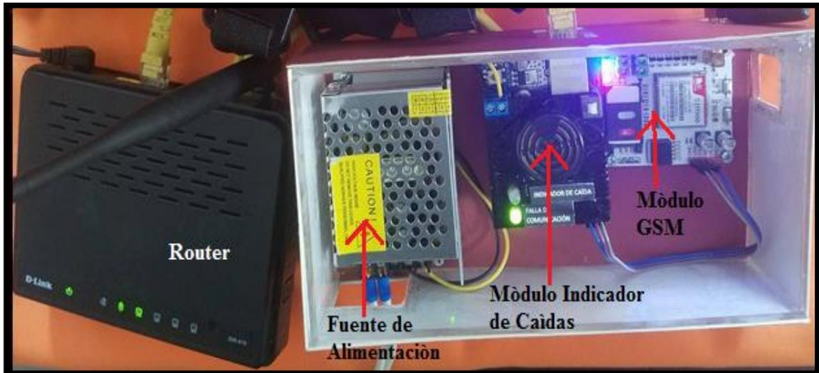
*Figura 75:Elementos del módulo central.*
