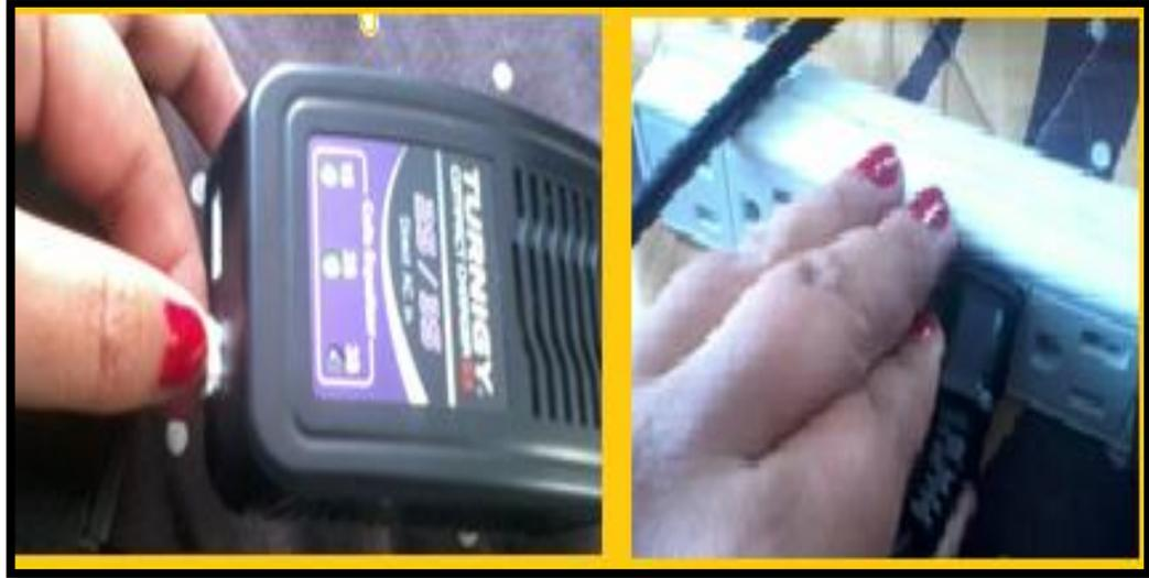
*Figura 9: Desconectar los cables del cargador*
