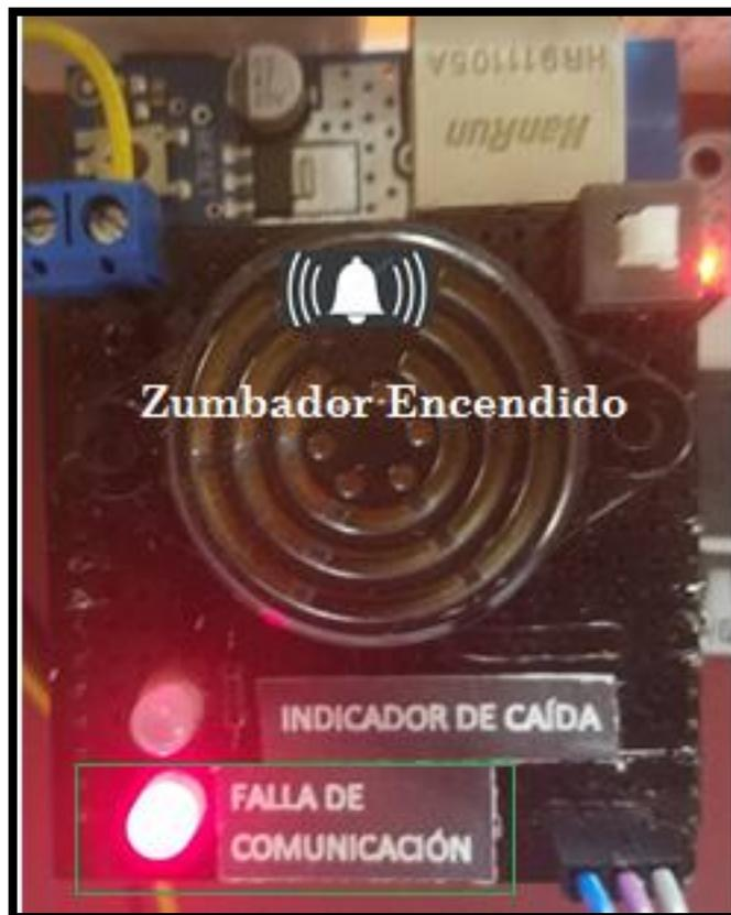
*Figura 69: Alarma de falla de comunicación con auditiva y visual.*
