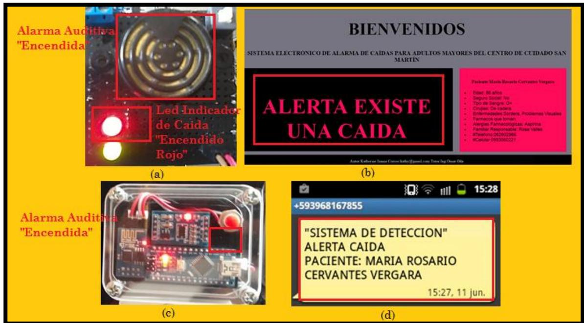
Figura 30: (a)Indicador de led y auditiva encendidos, (b)Servidor Web, (c) Alarma auditiva encendida en módulo sensor, (d)Envío de mensaje de texto
