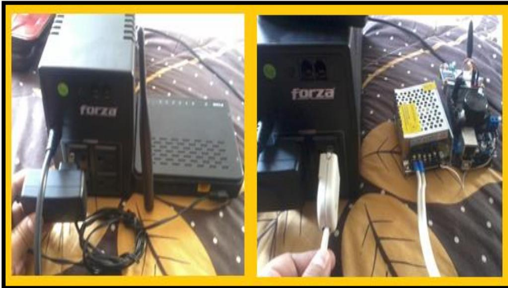
*Figura 1590: Conexión del Router y Fuente de alimentación al UPS*
