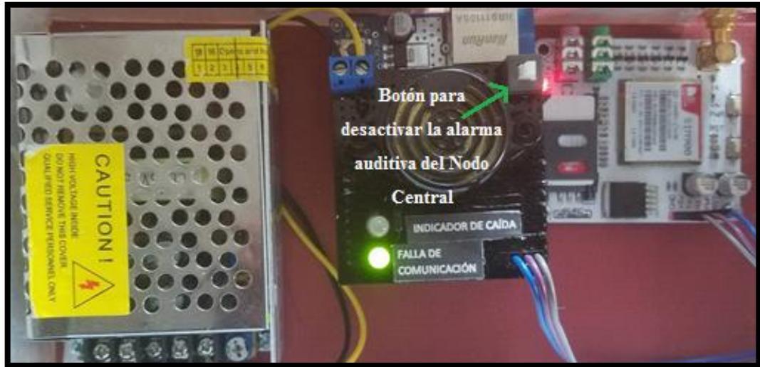
Figura 70: Botón para desactivar la alarma auditiva del módulo Central.
