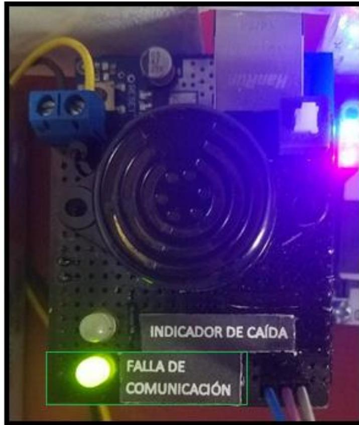
*Figura 68. Comunicación entre el módulo central y sensor.*
