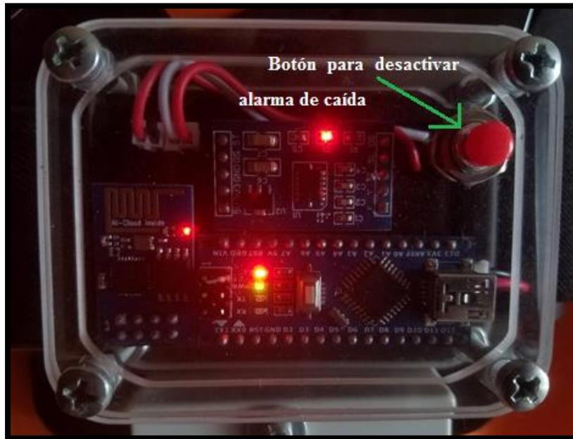
Figura 72. Desactivación de la alarma
