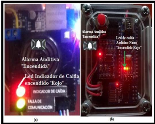
Figure 13: Alarm auditory y Visual (a) Módulo Central (b)Módulo Sensor.
