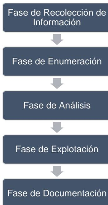
Ilustración 2.1 Orden de ejecución de las fases del Pentesting.
