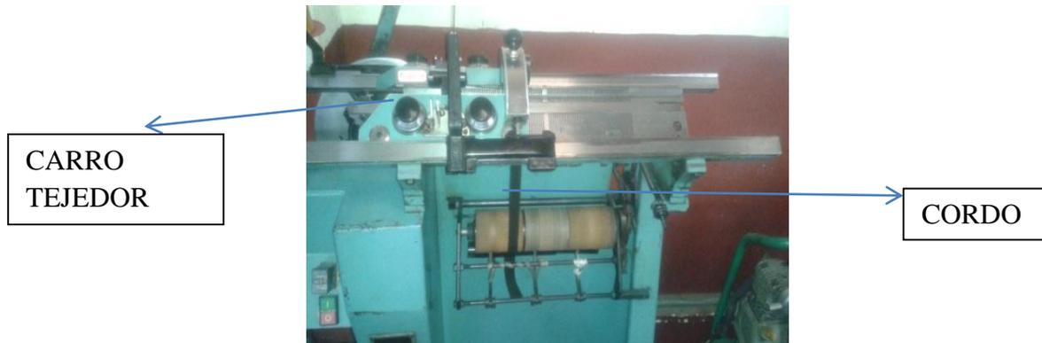
**Figura 19** Carro tejedor de una maquina rectilínea para tejer cordones
