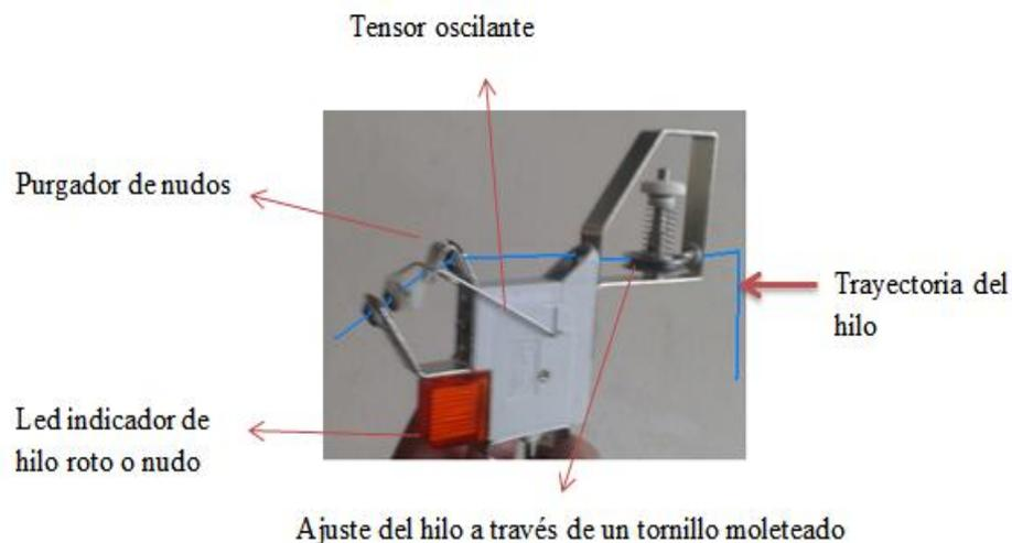
**Figura 44** Guía hilo de nudos e hilos rotos trabajando en condiciones normales
