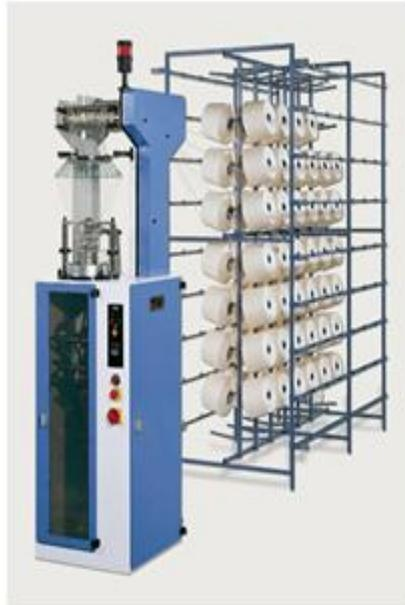
**Figura 12** Fileta trasera de alimentación de hilos,
