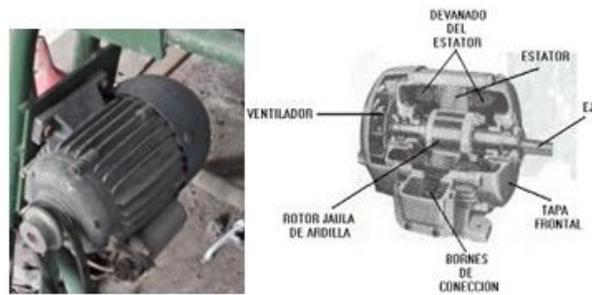
**Figura 30** Motor de la máquina cordonera tipo jaula de ardilla
