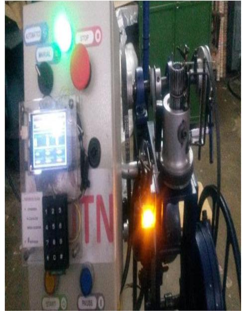
**Figura 73 Led encendido de aguja rota**
