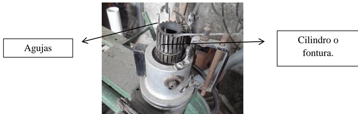
**Figura 23** Fontura o cilindro de la máquina cordonera
