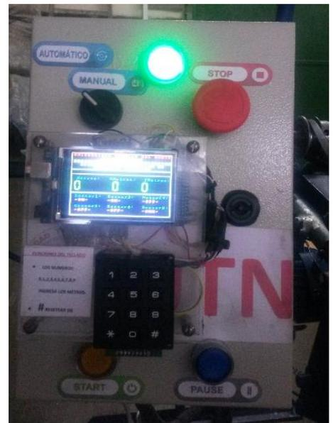
Figura 71 Tablero de control ensamblado con todos sus partes
