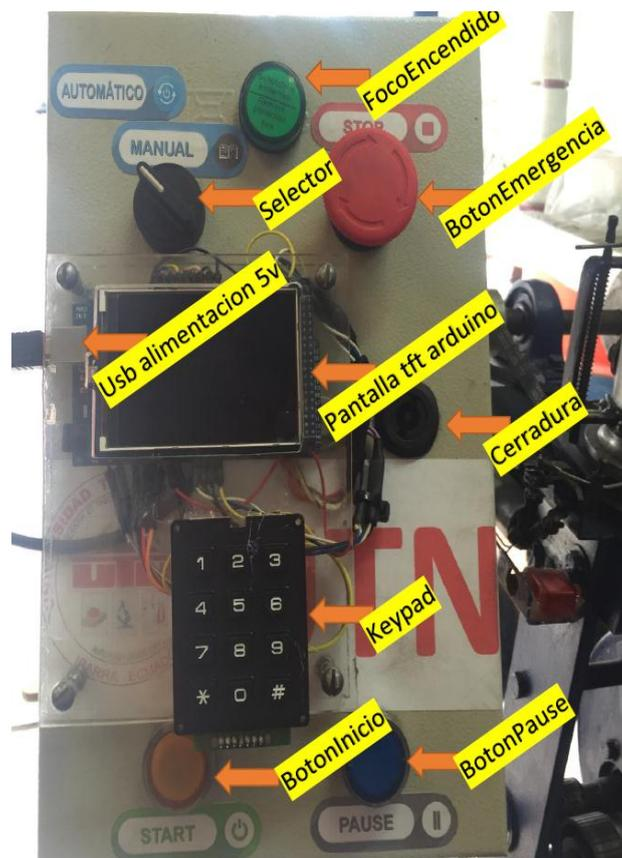
**Figura 59** Tablero de control exteriormente
