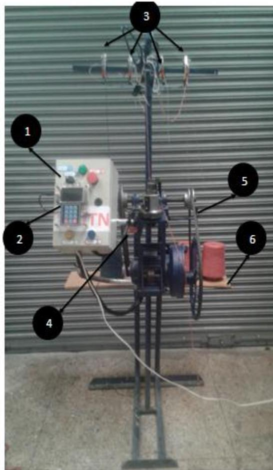
**Figura 57** Máquina cordonera automatizada terminada con todos sus nuevas partes y sistemas implementados.
