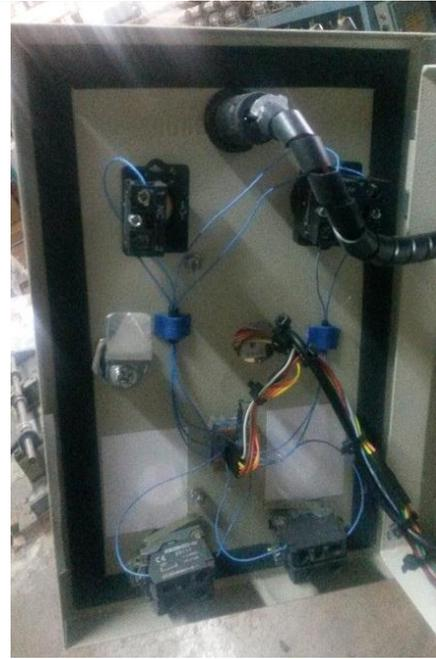
**Figura 78 Conexiones instaladas de los pulsadores**
