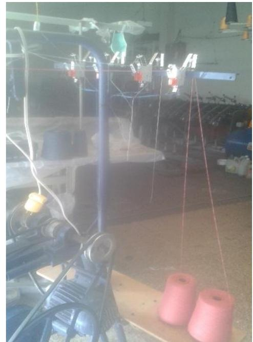
**Figura 75 fileta de conos con su respectivo guía hilo electrónico**
