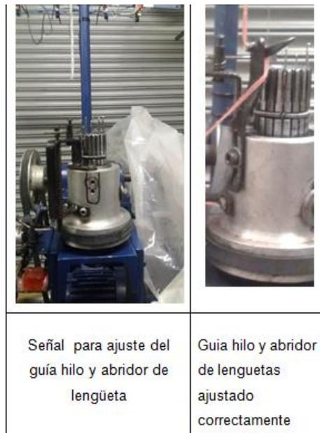
**Figura 65 Ajuste del guía hilo fijo y abridor de lengüetas de aguja.**
