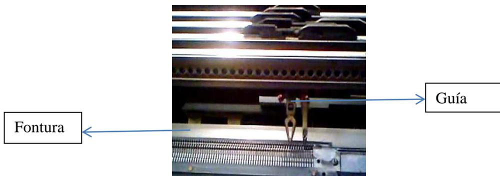
**Figura 18** Guía hilos de maquina rectilínea
