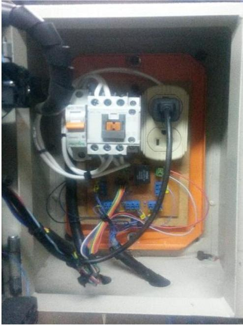
**Figura 76 Conexiones instaladas por dentro del tablero de control**
