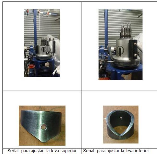
**Figura 66 Señal para la calibración exacta del cerrojo de la leva superior e inferior.**
