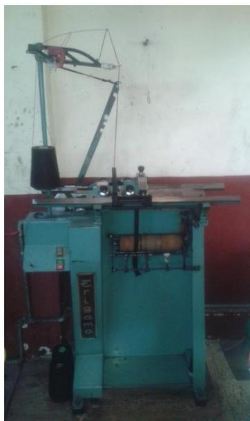
**Figura 21 Bancada de máquina cordonera rectilínea**
