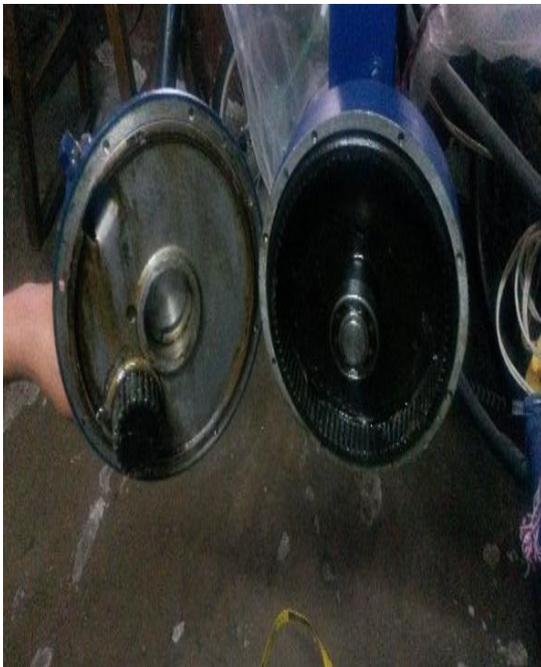
**Figura 74 Piñones reductores de los cilindros de arrastre por dentro**
