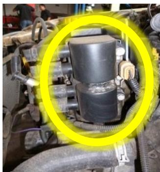
Figura 8. Ubicación Bobina de ignición.
