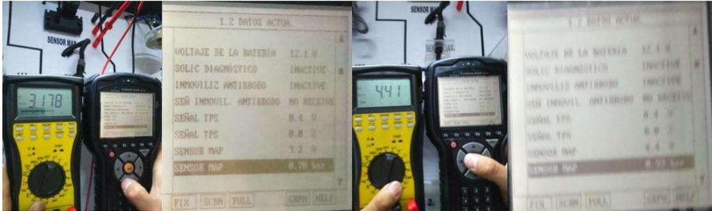
Figura 14. Toma de datos del sensor MAP
