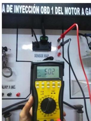
Figura 13. Señal del sensor MAP.
