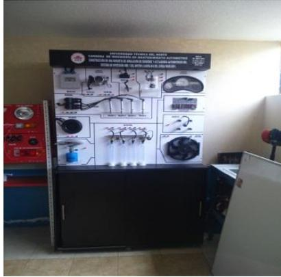
Figura 10. Maqueta interactiva del funcionamiento de sensores y actuadores de un vehículo
