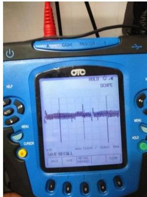
Figura 11. Forma de onda sensor CKP
