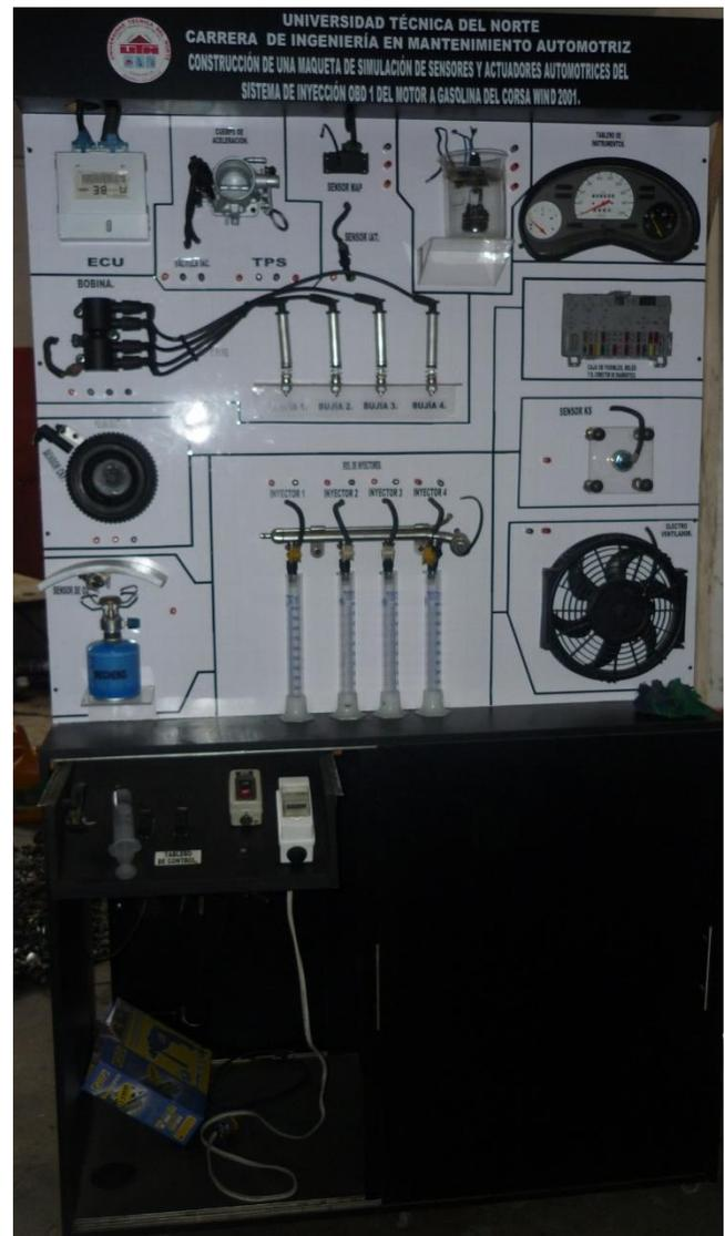
**Ilustración 1 Maqueta de simulación finalizada.**
