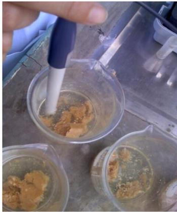
Foto 9: Potenciómetro y muestra
