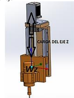
Figura 13. Imagen del diseño y la masa del eje “Z”
