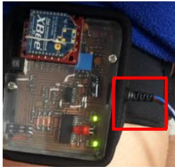
6. Se conecta el módulo XBee S1 al puerto de la computadora.
