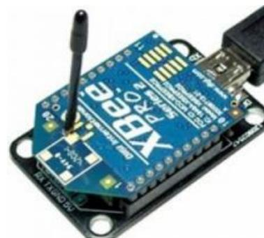
Figura 3.13 Módulo XBee.
