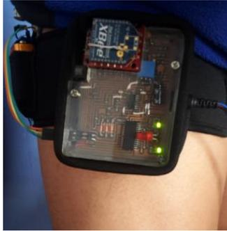
5. Conectar los cables de transmisión de señal al prototipo, los cables tienen un orden de colocación, el cable rojo y azul se conectan en el músculo de interés mientras que el de color negro se le conecta al electrodo de referencia.
