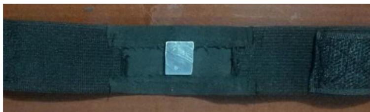
**Figura 4.29 Electrodo de referencia.**
