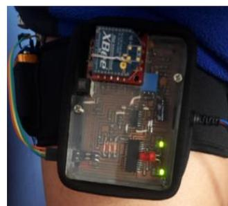
Figura 4.18 XBee alimentación con baterías.
