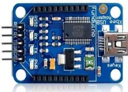
Figura 3.12 XBee Explorer.
