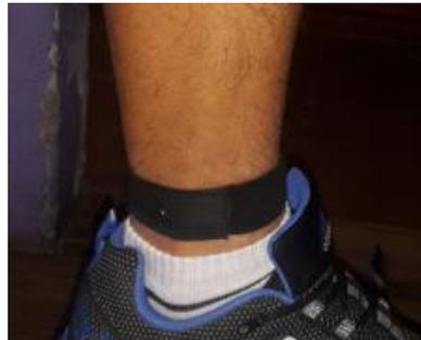
Figura 4.50 Electrodo de referencia de acero inoxidable.
