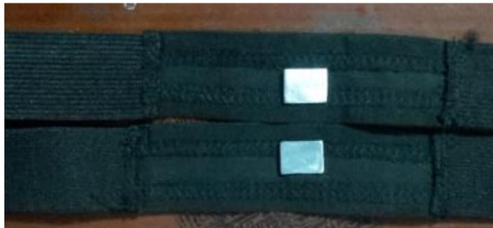
**Figura 4.28 Banda con electrodos (inversor y no inversor).**
