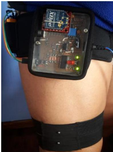
**Figura 4.41** Colocación de todo el prototipo en el muslo.
