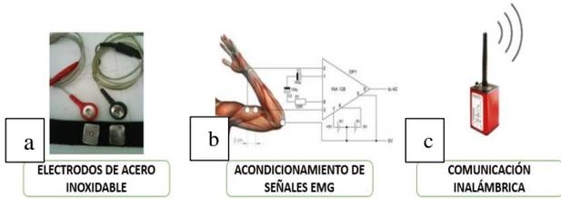
Fig. 4. Diagrama de bloques del sistema. a) Electrodo de acero inoxidable, b) Acondicionamiento de la señal EMG, c) Comunicación inalámbrica
