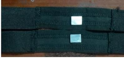
Fig. 2. Banda con electrodos (inversor y no inversor)
