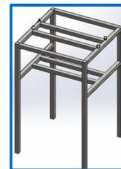
Figura 13: **Estructura de la máquina selladora de vasos**
