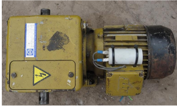
Figura 2.11 Motor-reductor de las cortinas posteriores
