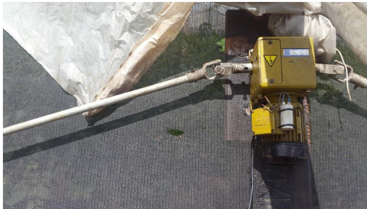
Figura 3.31 Acoplamiento de Junta universal al motor-reductor y barra de mando
