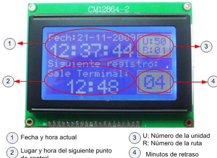
**Fig. 3. Pantalla GLCD del Módulo Usuario**
