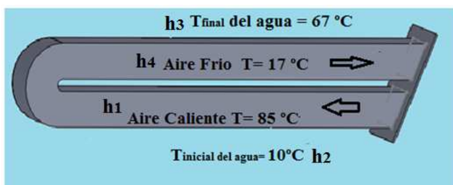
Figura 106.- Entalpías en la transferencia de calor del intercambiador al agua de la tina de escaldado.
