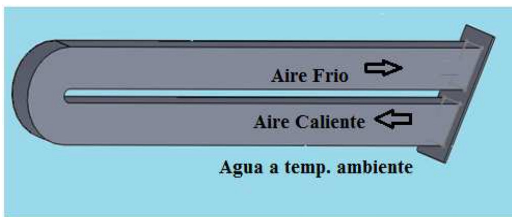
Figura 104.-Condiciones iniciales del intercambiador de calor.
