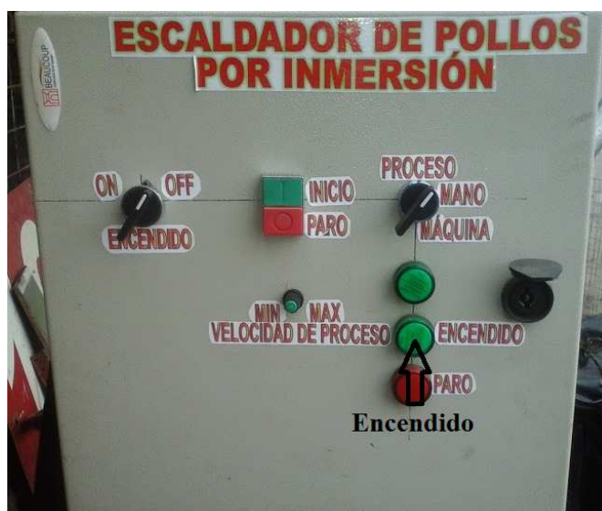
Figura 133.- Luz piloto que indica que la máquina esta energizada.
