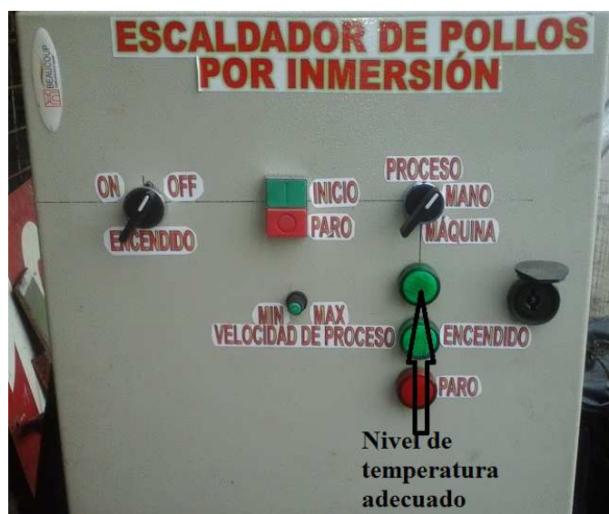
Figura 134.- Nivel de temperatura adecuado para el escaldado.
