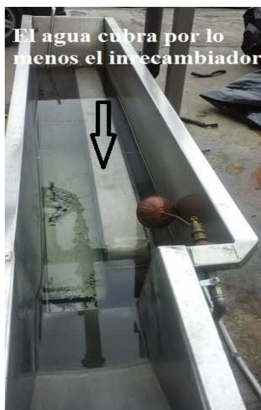
Figura 127.- Para el encendido verificar que el agua cubra por lo menos la totalidad del intercambiador de calor.
