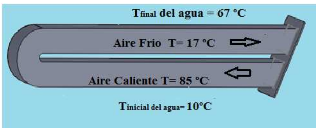
Figura 105.- Condición final de la temperatura del agua.
