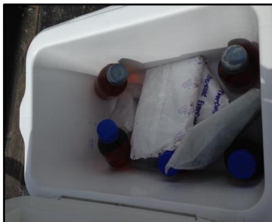
Fotografía 14. Transporte de muestras en cooler controlando la temperatura
