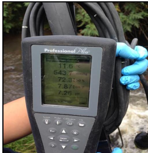
**Fotografía 13. Equipo multiparamétrico para análisis *in situ***
