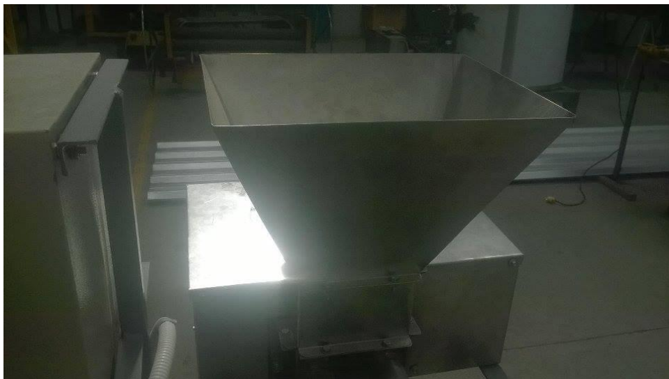
FIGURA 54 Montaje de la tolva
