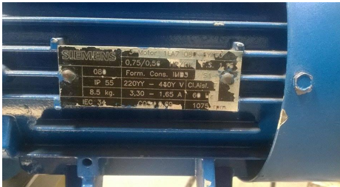
FIGURA 15 características del motor
