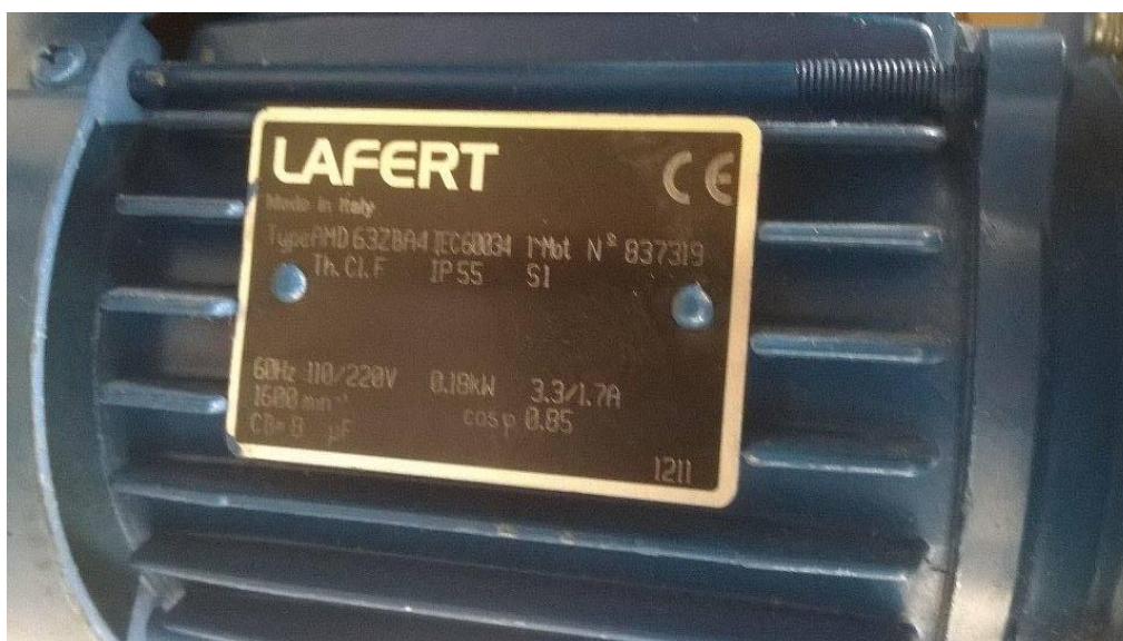
FIGURA 18 Características del motor para la banda transportadora
