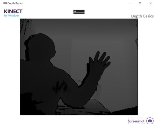
FIGURA 3.9: Imagen de profundidad usando Kinect
