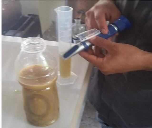
Figura. 20. Control de grados Brix (Refractómetro de mano marca “Alla France”).
