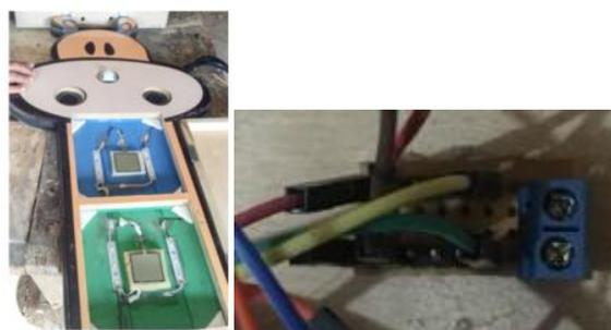
Figura 11: Ensamblaje y placa del sensor infrarrojo vista frontal y pistas soldadas vista posterior.
