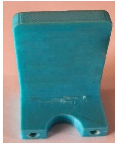
Fig. 8. Mejora para evitar la pérdida de posición del extrusor.
