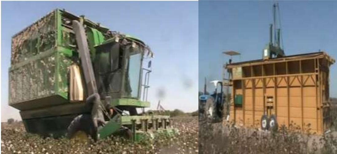
FOTO 3: Máquina piscadora y modulador.
