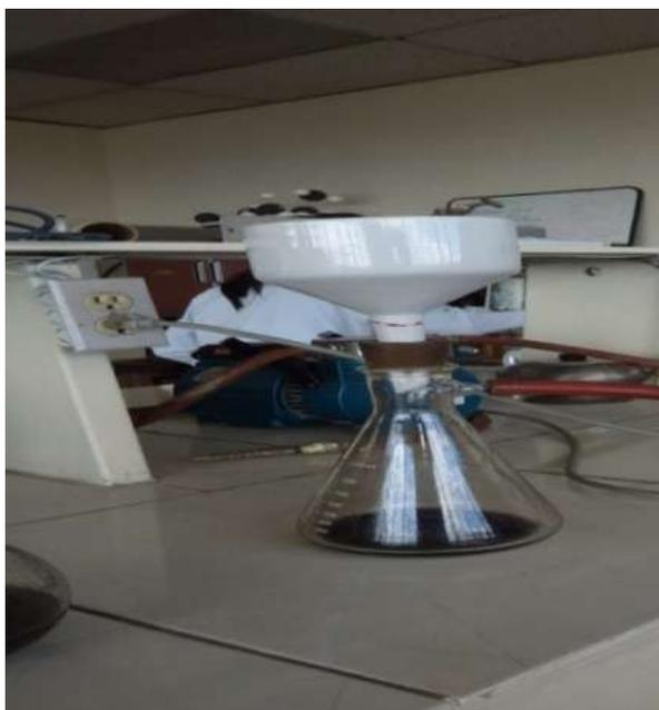
**FOTO 25:** Filtrado con bomba de vaciado.
