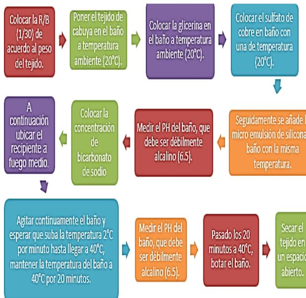
Para el proceso de impregnación de sulfato de cobre para dar una propiedad antibacteriana a las plantillas de cabuya, se ha elaborado una hoja de patrón o consumo en donde existen los procesos realizados, los de productos textiles utilizados y otra información adicional.
