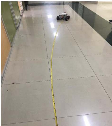
Figura 3.10. Prueba de campo de trayectoria rectilínea en superficie lisa
