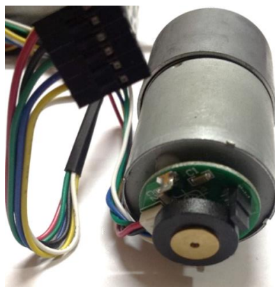
Figura 2.4. Codificador acoplado al motor
