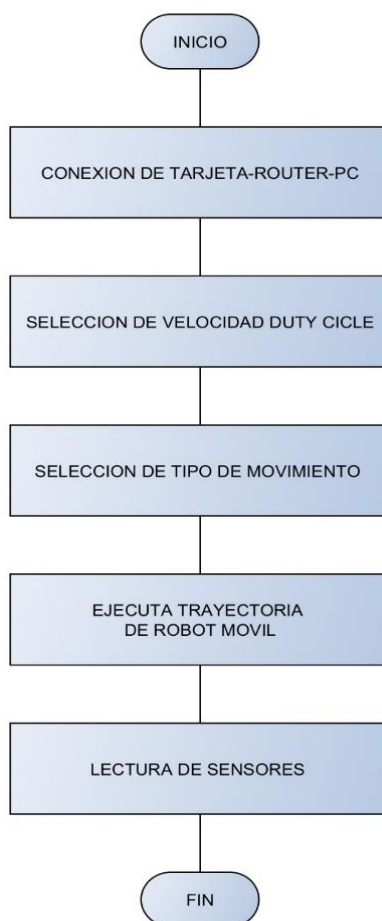
Figura 2.21. Diagrama de flujo de funcionamiento de la plataforma
