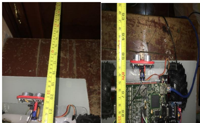
Figura 3.6. Toma de datos de distancia sensor ping
