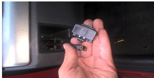
Figura 3.91. Instalación del interruptor del neblinero LED
