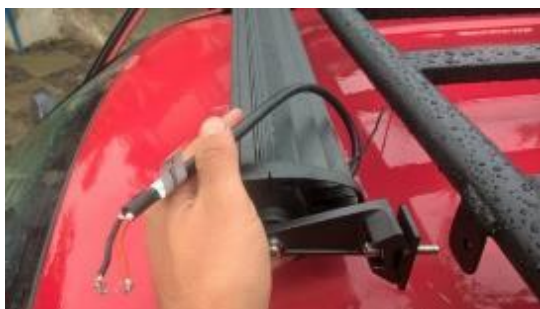
Figura 3.87. Montaje del neblinero LED
