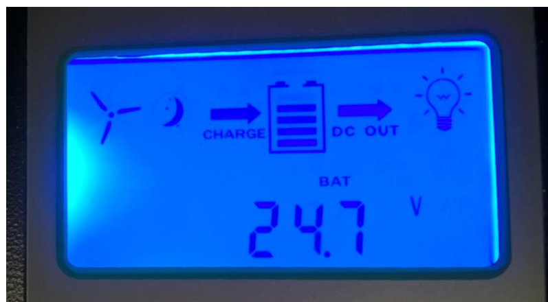
Figura 4.22. Estado de la batería después de encender el neblinero led
