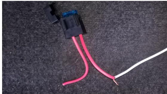
Figura 3.93. Instalación del fusible del neblinero LED
