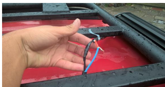
Figura 3.94. Instalación de la alimentación de corriente del neblinero LED
