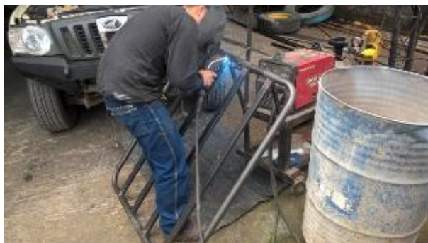
Figura 3.57. Soldadura de los soportes dentro de la parrilla
