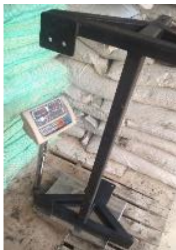
Figura 3.47. Pesaje de la estructura del Savonius
