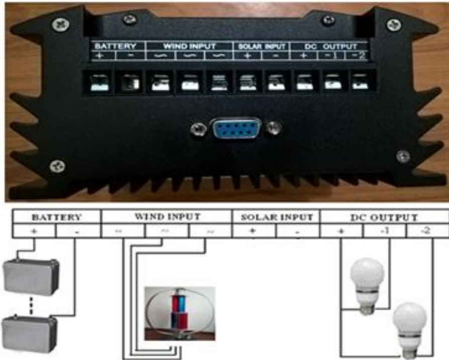
Figura 3.38. Puertos de conexión del controlador de carga
