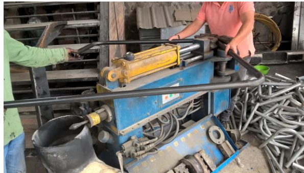
Figura 3.53. Proceso de doblado del tubo con perfil circular
