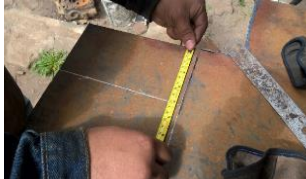
Figura 3.58. Corte del tol para la obtención de los asientos
