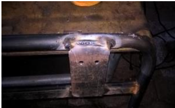
Figura 3.59. Proceso de soldadura de los asientos en la parrilla
