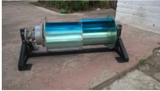
Figura 3.85. Montaje del Savonius en su estructura
