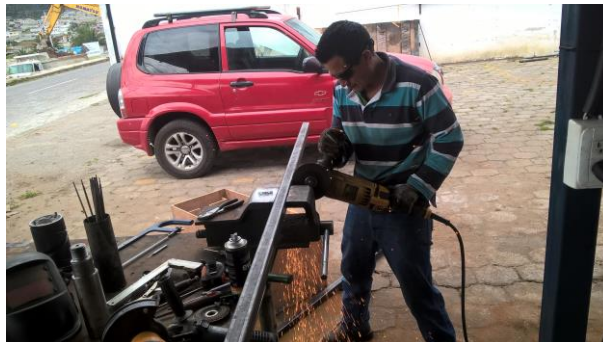
Figura 3.70. Corte de los tubos para la estructura del Savonius
