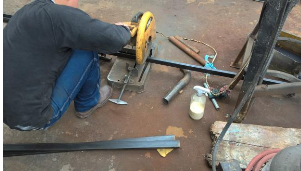
Figura 3.55. Corte del tubo con contorno rectangular
