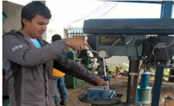
Figura 3.81. Perforación en los soportes de la estructura del Savonius
