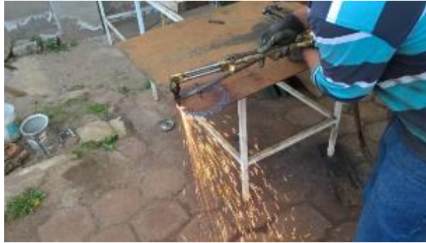
Figura 3.74. Corte del tol para los asientos del Savonius
