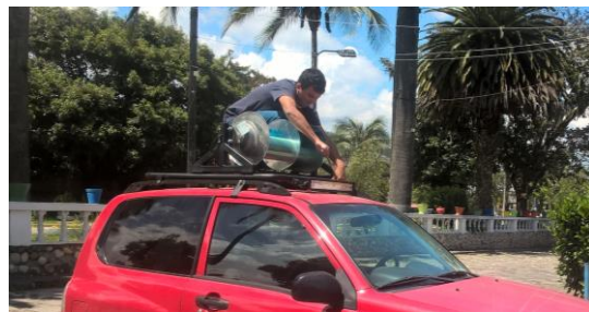
Figura 3.86. Montaje del Savonius y su estructura sobre la parrilla
