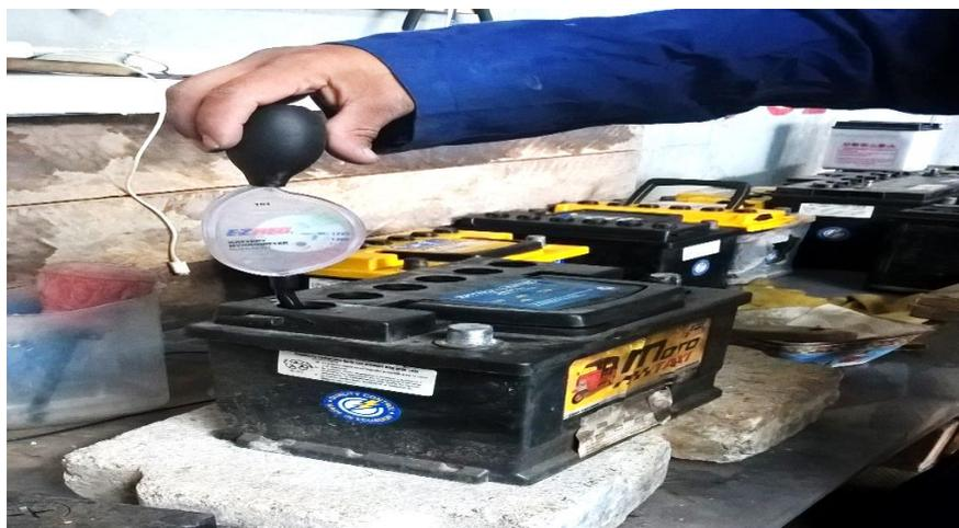
Figura 3.7. Medición densidad del electrolito.
