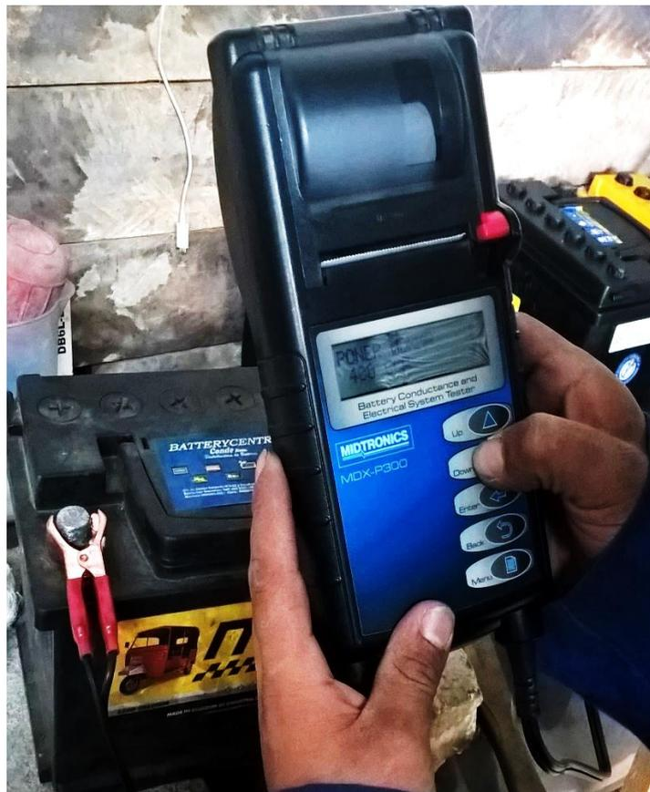
Figura 3.8. Diagnóstico de la batería con scanner
