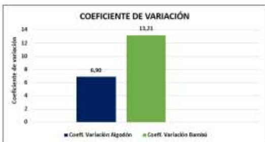
**Figura. 6.** Valores comparativos de la medición de degradación del color de tintura con colorantes reactivos, mediante el coeficiente de variación.
