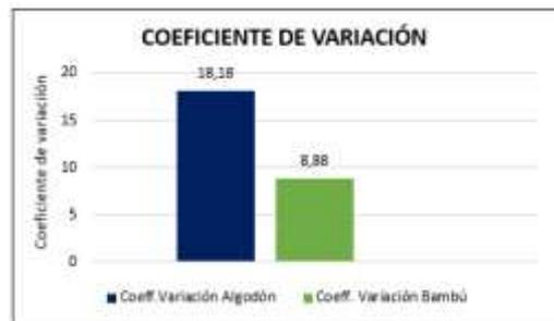
**Figura. 8.** Valores comparativos de la medición de degradación del color en tela cruda de algodón y bambú, mediante el coeficiente de variación.
