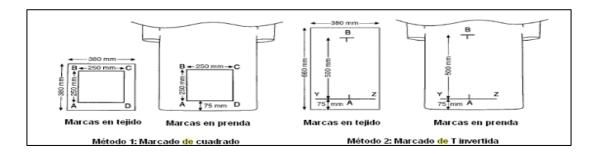
FIGURA 23: Ensayo para Determinar el Desgaste a la Luz
