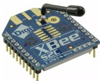
*Ilustración 22. XBee S2C.*
