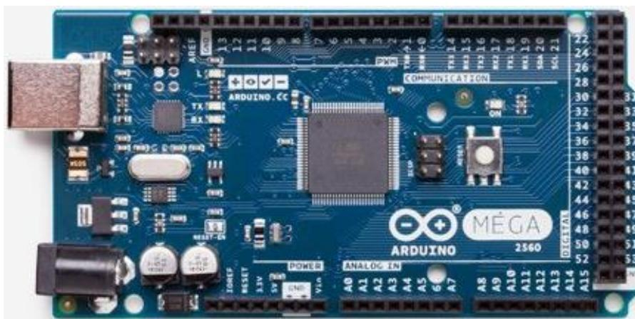
*Ilustración 20. Arduino Mega2560.*
