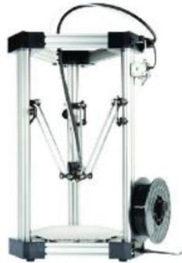
*Figura 1 Sistema tipo delta Fuente: (Sanches, 2015).*
