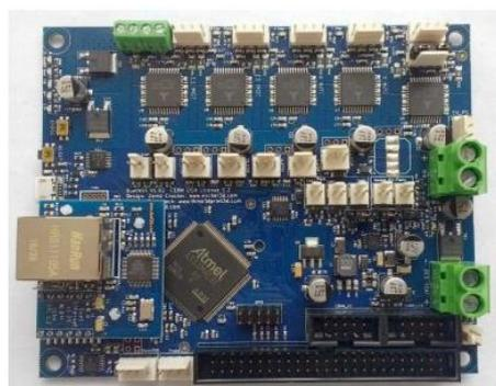
*Figura 11. Tarjeta duet Ethernet Fuente: (RepRap, 2016)*
