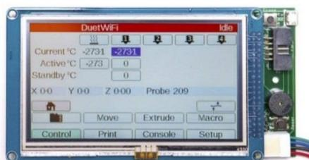
*Figura 12. Panel due Electrónica de impresión Fuente: (PanelDue for 3D printers, 2015)*
