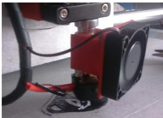
**Figura 40.** Proceso de impresión en dos colores, capa 3.
