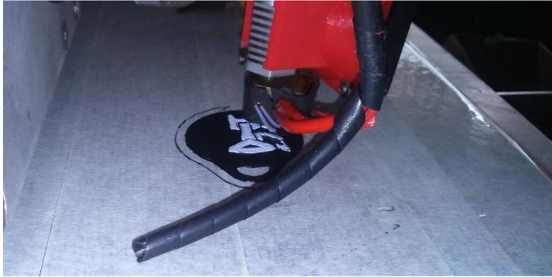
**Figura 41.** Proceso de impresión en dos colores, capa 5.
