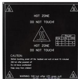
**Figura 17.** Base caliente tipo PCB FR4. **Fuente:** (SainSmart, 2017).
