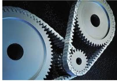
**Figura 9.** Transmisión por cadena. **Fuente:** (Montes, 2014)
