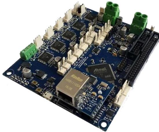
**Figura 15.** Tarjeta controladora Duet Ethernet. **Fuente:** (Filastruder, 2018).
