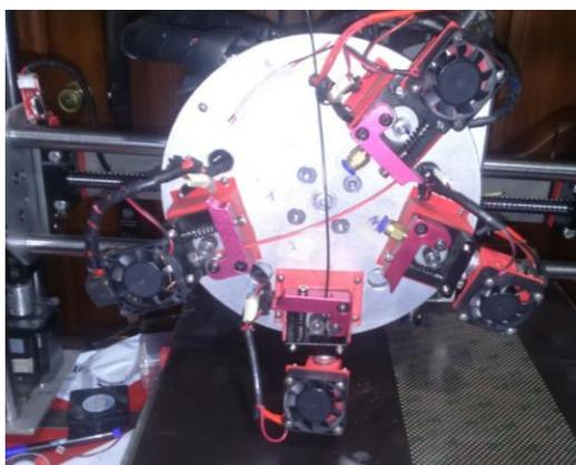
**Figura 37.** Sistema multiextrusor montado sobre el eje X.
