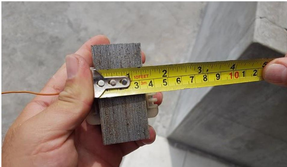
Figura 59 Medición de la sección del núcleo del ancho
