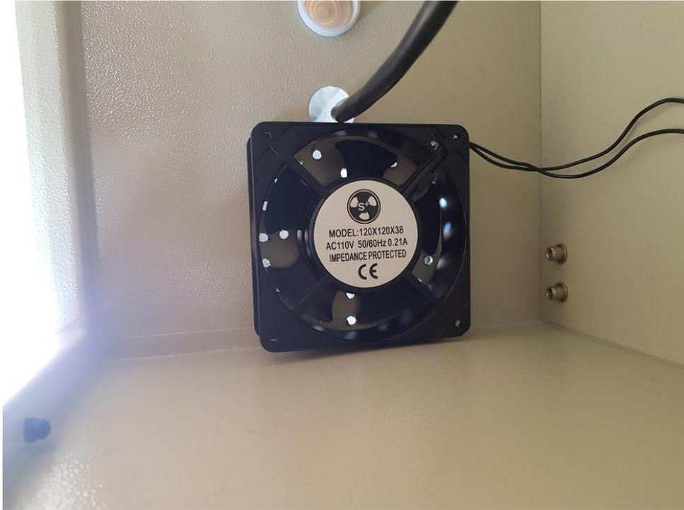
Figura 72 Montaje del ventilador
