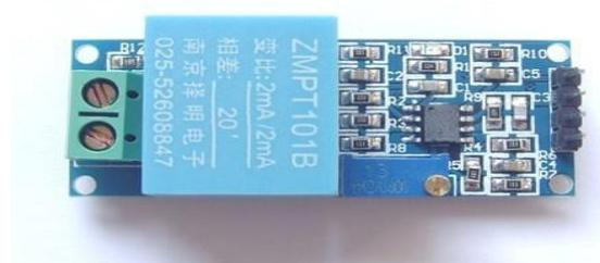
Figura 21 Acondicionador de señal de entrada (ZMPT101B)
