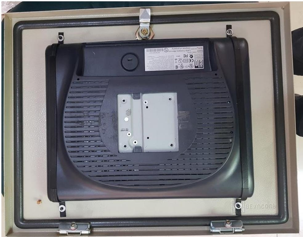
Figura 75 Montaje del HMI al módulo
