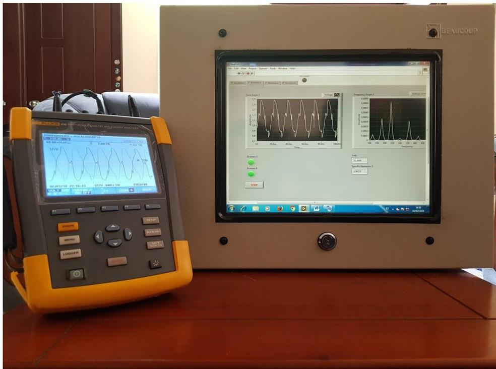
Figura 81 Comparación de ondas del 5<sup>to</sup> armónico
