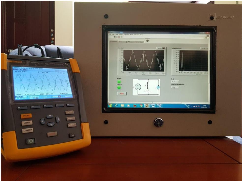
Figura 80 Comparación de ondas del 3<sup>er</sup> armónico
