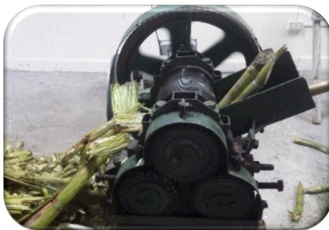
**Figura 2.** Molino de rodillos
