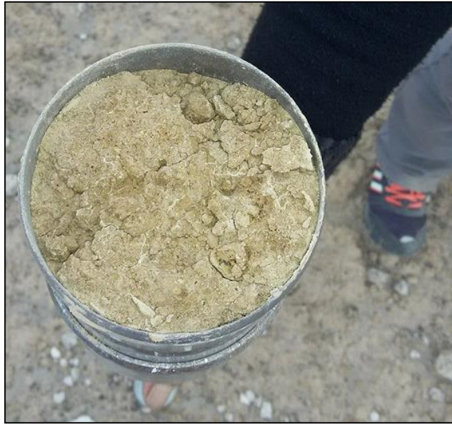
Figura 3.2 Muestra de densidad aparente con el barreno.
