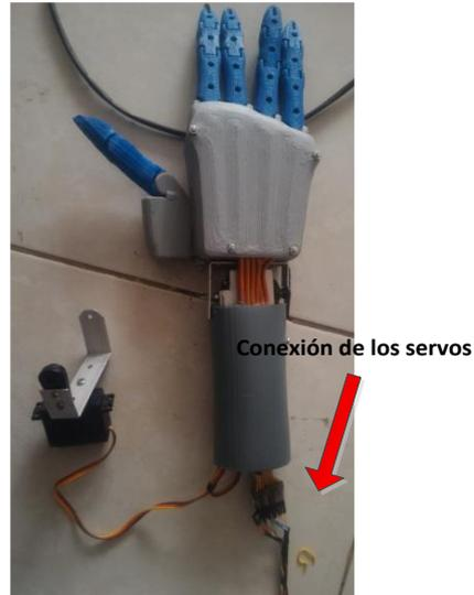
*Figura 73. Conexión de los servos.*
