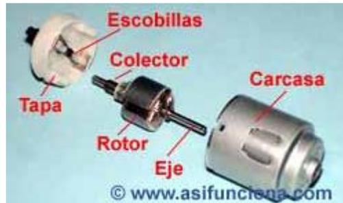
*Figura 28. Motor de Corriente Continua.*
