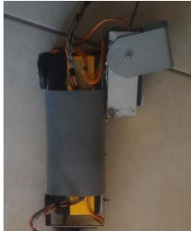
*Figura 76. Ensamblado del codo y del hombro.*
