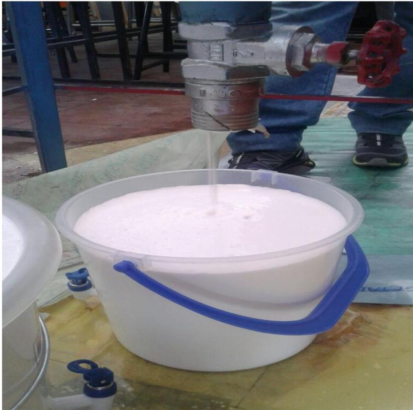
**Figura A1. 3** Finalización del proceso de transesterificación
