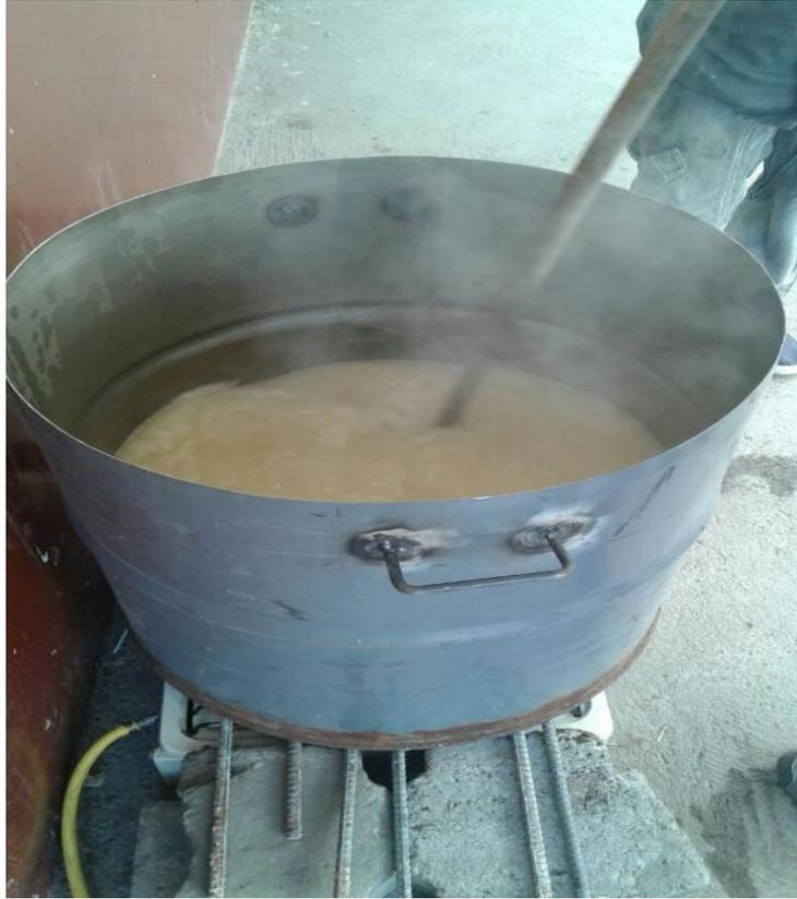
**Figura A1. 5** Proceso de lavado del biodiésel
