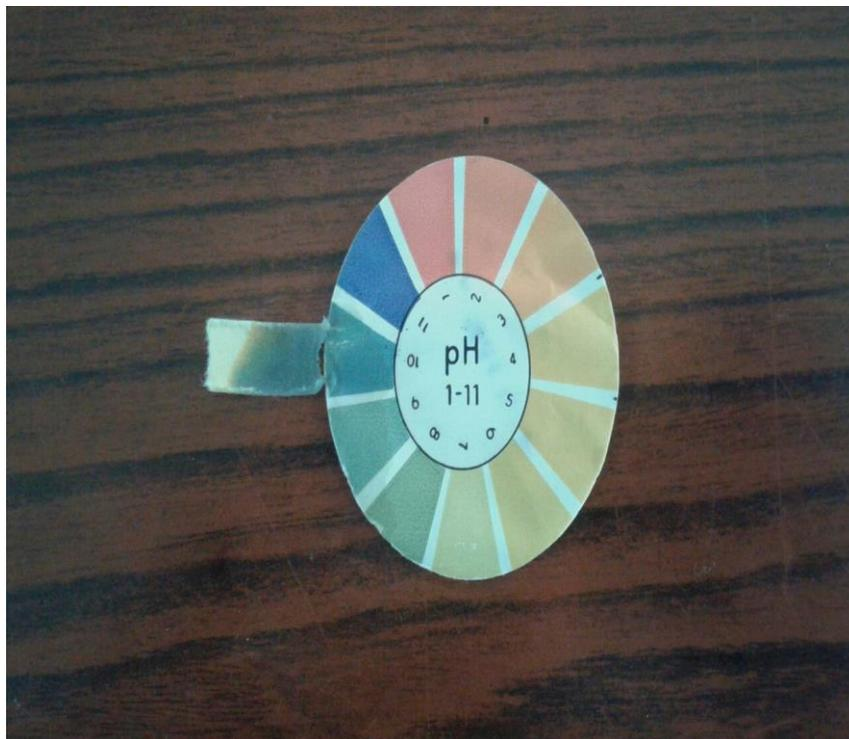
**Figura A1. 4** Comprobación de pH después de la transesterificación
