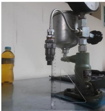
**Figura 5.13** Pruebas con inyectores mecánicos.
