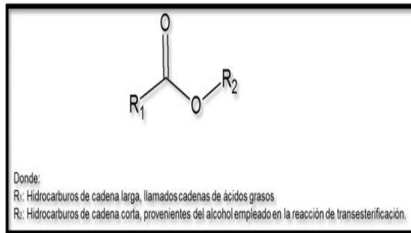
**Figura 0.2 Estructura química del biodiésel.**
