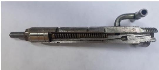
**Figura 5.10** Corte del inyector mecánico diésel.
