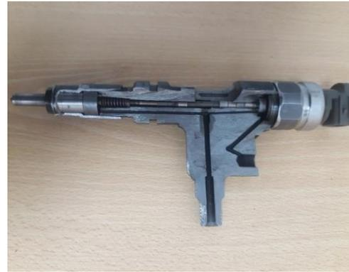
**Figura 5.11** Inyector electrónico diésel.
