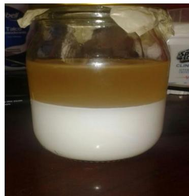
**Figura 5.6** Lavado del biodiésel con agua.
