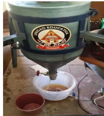
**Figura 5.5** Decantación del biodiésel por reposo.
