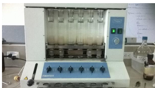
Figura 11. Equipo para obtención de extracto etéreo
