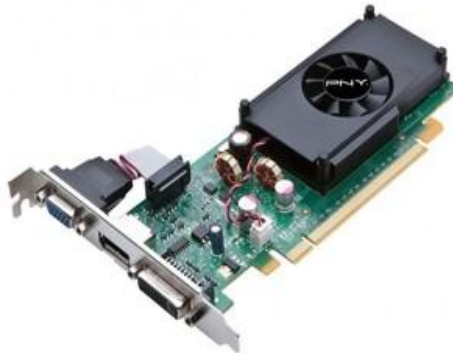
Ilustración 189 Tarjeta de video
