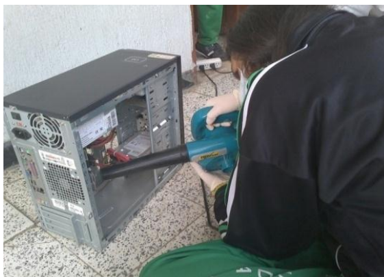
Ilustración 127 Limpieza interna del CPU
