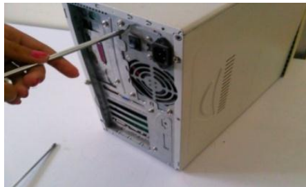
Ilustración 126 Desarmado del CPU
