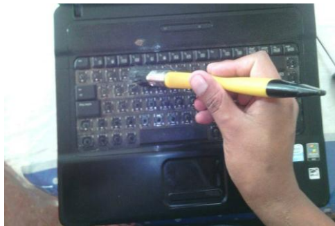
Ilustración 136 Limpieza interna del teclado
