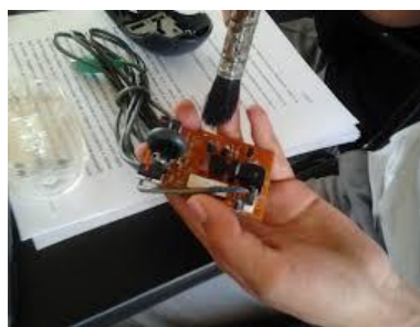
Ilustración 132 Limpieza interna del mouse
