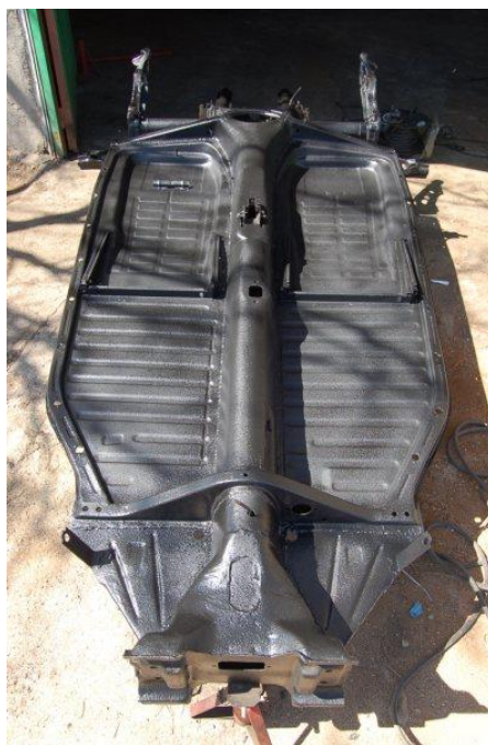
Figura 3.7: Restauración del piso del vehículo
