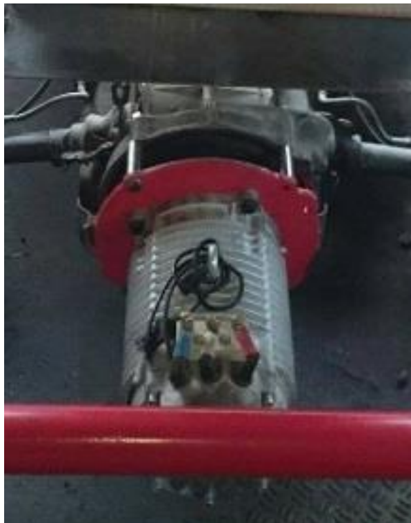
Figura 4.3: Motor acoplado a la caja de cambios
