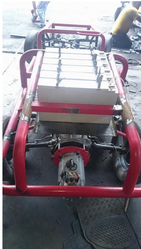
FIGURA AIII.4: Ubicación de las baterías
