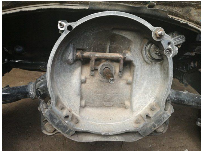
Figura 3.1: Caja de cambios manual vista frontal
