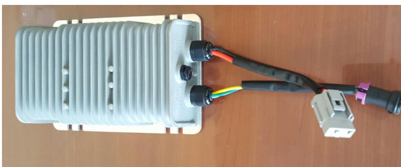
Figura 2.27: Convertidor DC DC 72V - 12V - 500W
