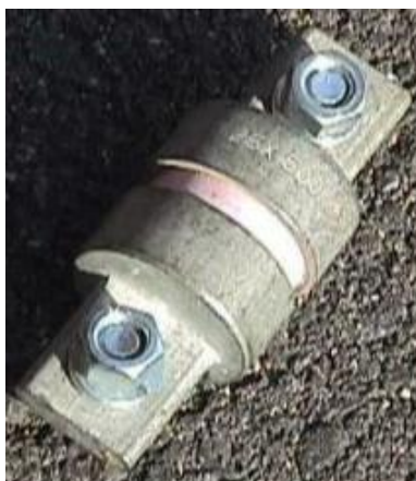
Figura 2.15: Fusible usado en protecciones
