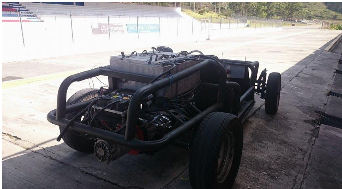
FIGURA AIII.7: Maquetan realizando pruebas de autonomía
