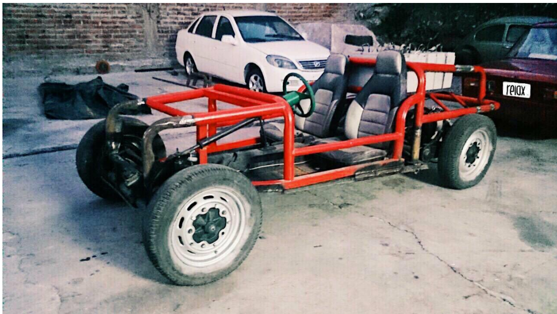
FIGURA AIII.6: Construcción del roll bar terminada
