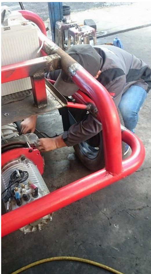
Figura 3.18: Adaptación del motor eléctrico a la caja de cambios
