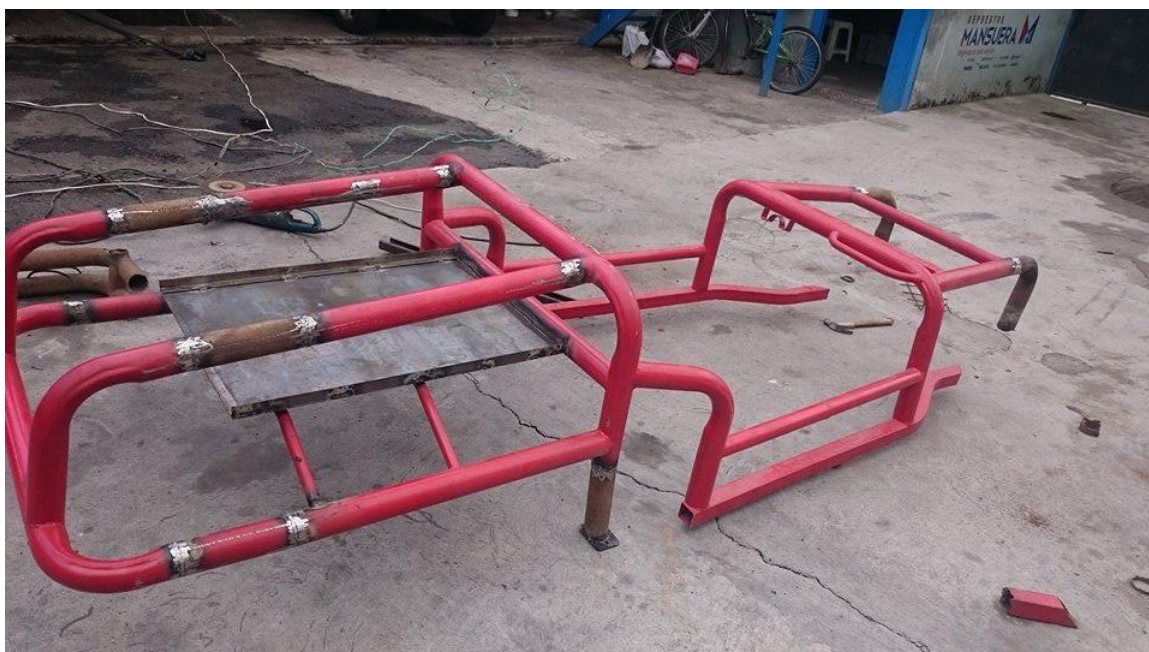
Figura 4.4: Construcción del roll bar
