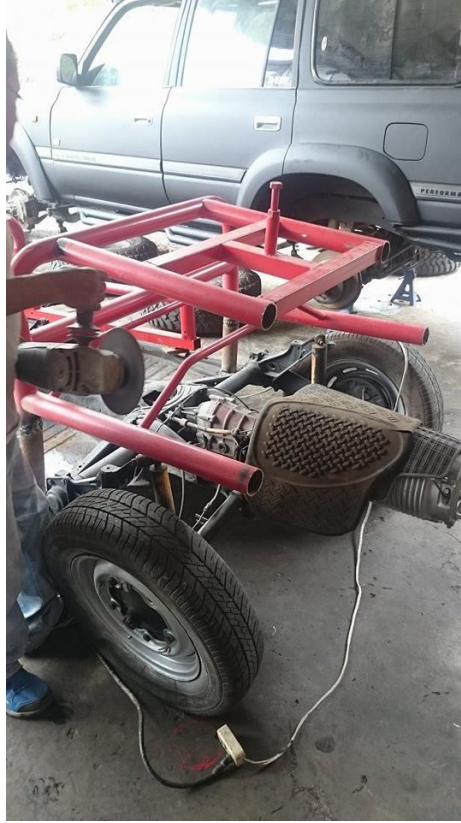
FIGURA AIII.3: Construcción del roll bar
