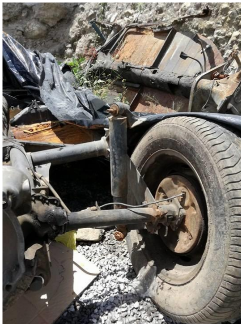
Figura 3.6: Sistema de amortiguación deteriorado
