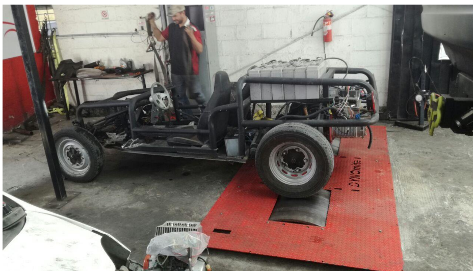
Figura 4.5: Aseguramiento de la maqueta al dinamómetro
