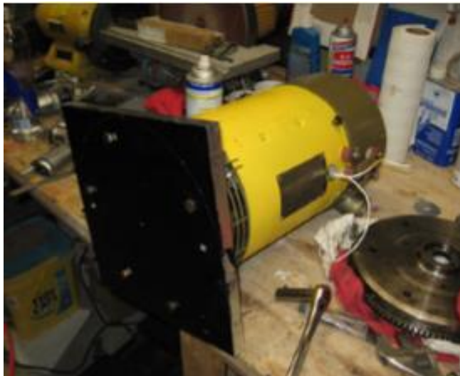
Figura 4.1: Acople de sujeción del motor a la caja de cambios
