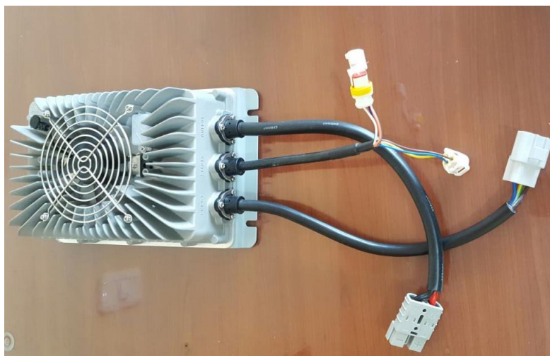
Figura 2.26: Cargador de baterías de cuatro etapas 2,5 Kw 72V
