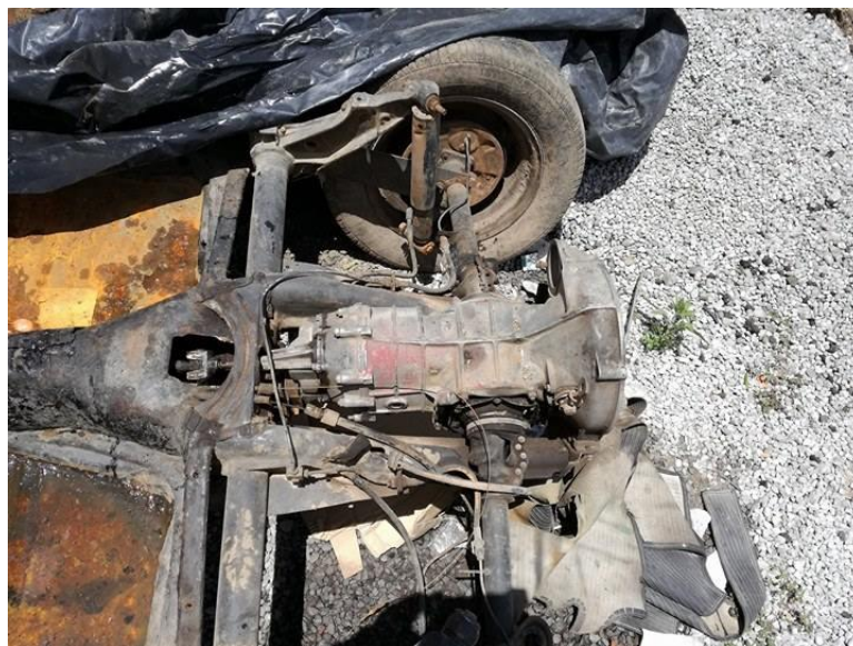
Figura 3.2: Caja de cambios manual vista preliminar
