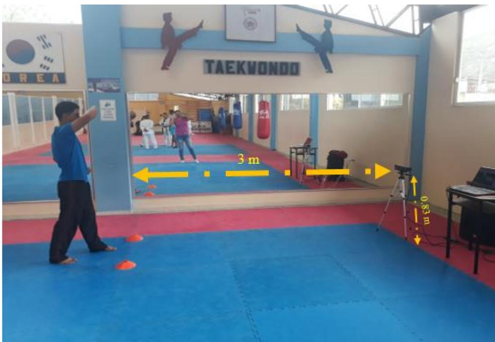
*Figura 24.* Ubicación del sensor Kinect v2.
