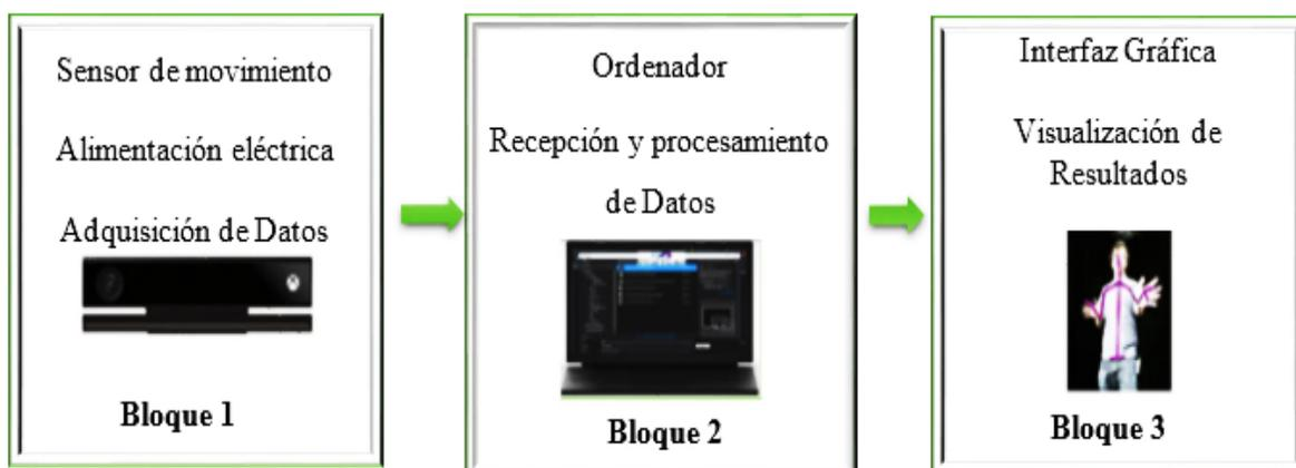
Figura 5. Diagrama de bloques del sistema de captura de movimiento.
