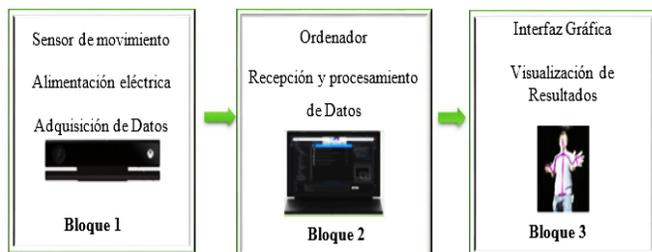
Figura 1. Diagrama de bloques sistema de captura de movimiento.
